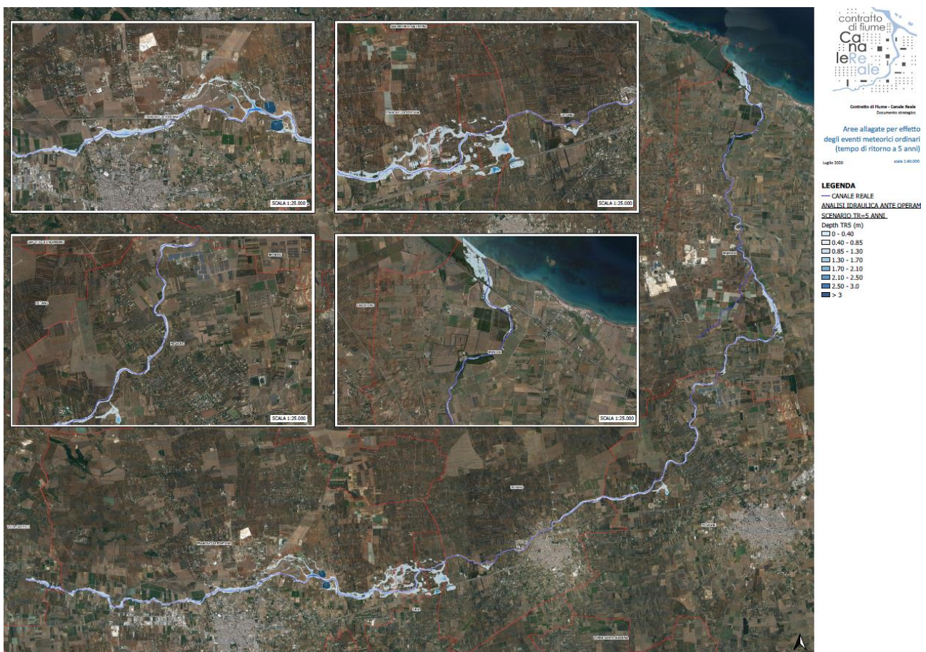
Fig. 33. Mappa dei tiranti idrici. Simulazione B. Stato di fatto e portata con T_r = 5 anni
