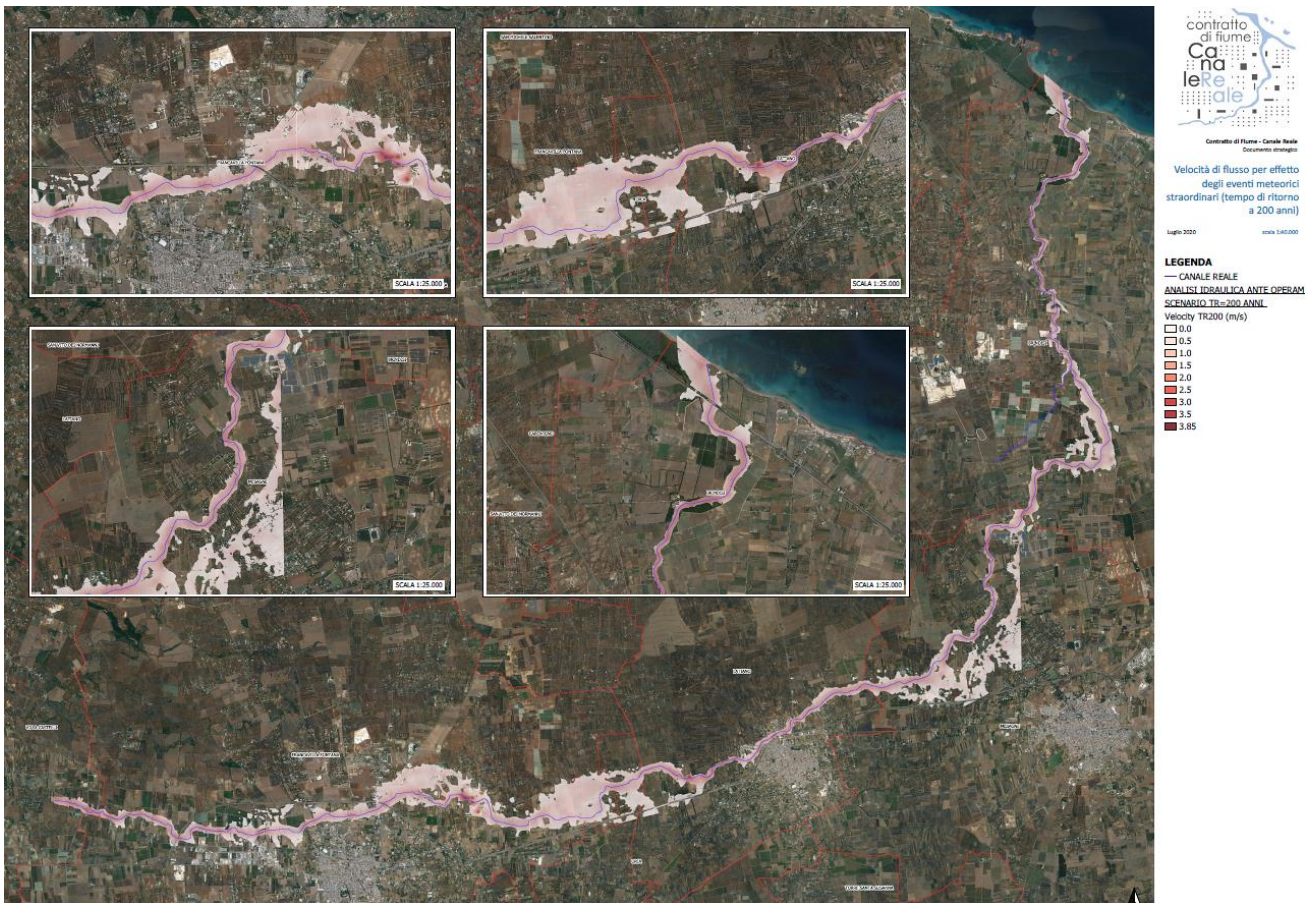
Fig. 31. Mappa delle velocità di deflusso. Simulazione A. Stato di fatto e portata con Tr = 200 anni
