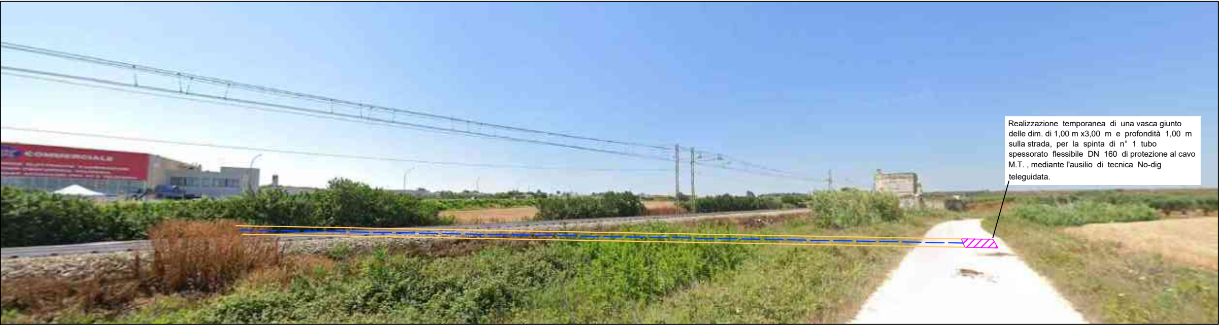
Nuova linea interrata in cavo Al 185 mmq MT da realizzare con tecnica No-dig teleguidata. Attraversamento trasversale della linea ferroviaria RFI.
