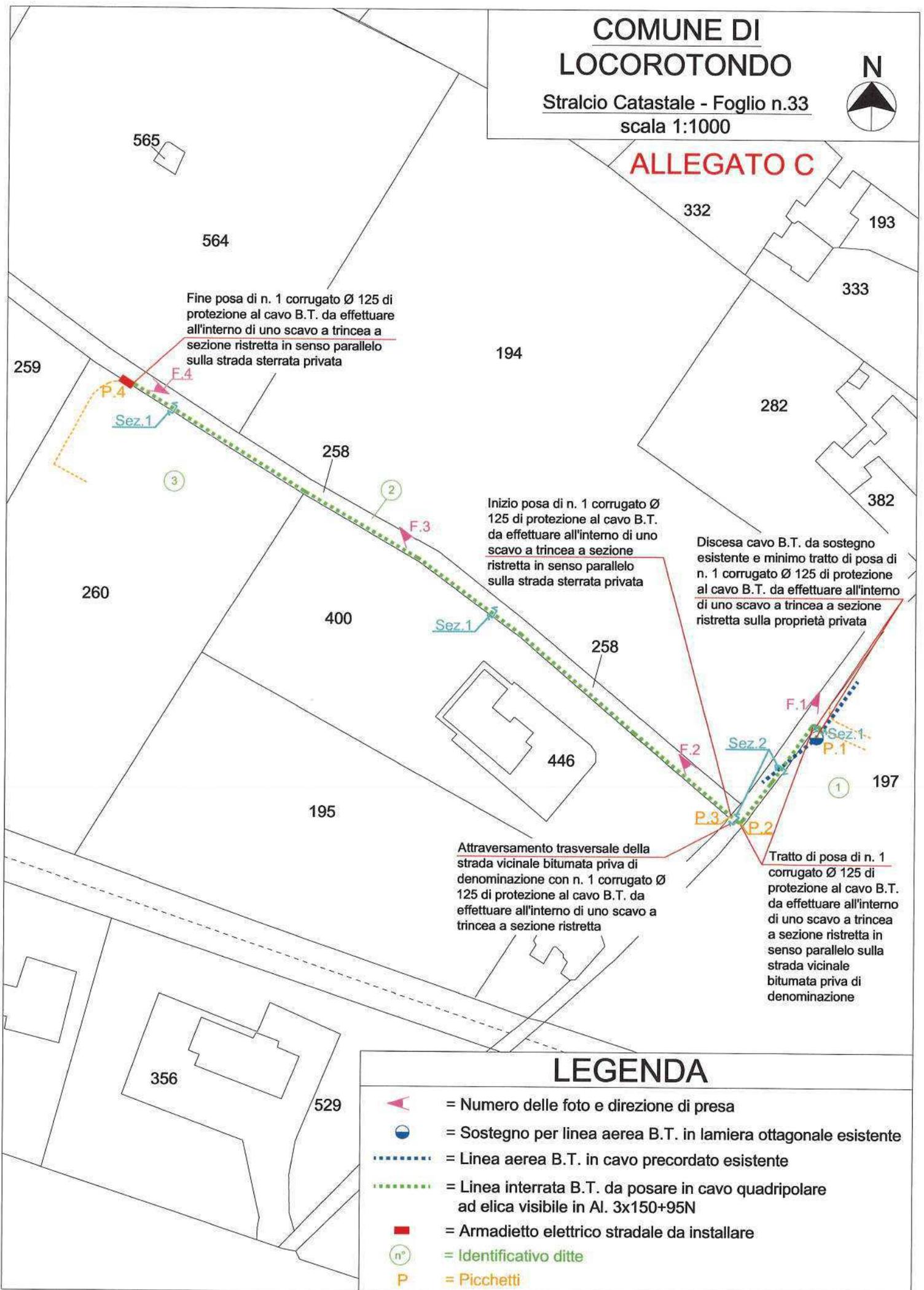
Fine posa di n. 1 corrugato Ø 125 di protezione al cavo B.T. da effettuare all'interno di uno scavo a trincea a sezione ristretta in senso parallelo sulla strada sterrata privata
