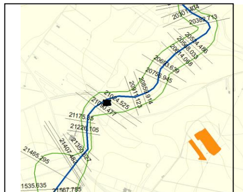
Figura 2.2 – Rappresentazione della morfologia del corso d'acqua In nero le tracce delle sezioni trasversali, in verde e in blu rispettivamente le sponde e l'asse del corso d'acqua. Con il simbolo nero sono rappresentati gli attraversamenti viari.
